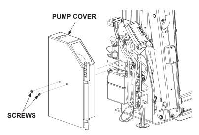
UNBOLTING/BOLTING PUMP COVER (LH PUMP SHOWN) FIG. 39-2
